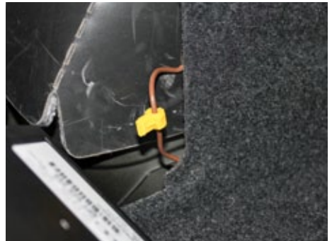
Anbringen der beiden Abzweigverbinder für die Stromversorgung des Moduls.
