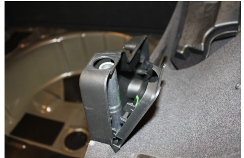
Schließen des Kunststoffgehäuses und einsetzen des Gummipuffers
