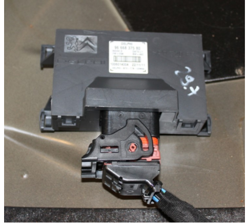
Anstecken des Kabelbaums an das Steuergerät
