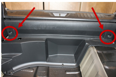
Rückwertige Kunststoffverkleidung entfernen
