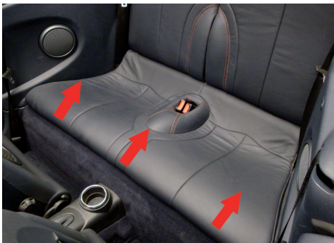
Sitzfläche an der Vorderkante nach oben ziehen.
