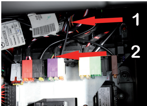
Abzweigverbinder an den Positionen 1 und 2 anbringen und mit den Kabeln des Modulkabelbaums verbinden.
