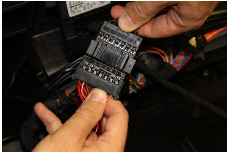
Verbinden des Steckers mit dem Modulkabelbaum
