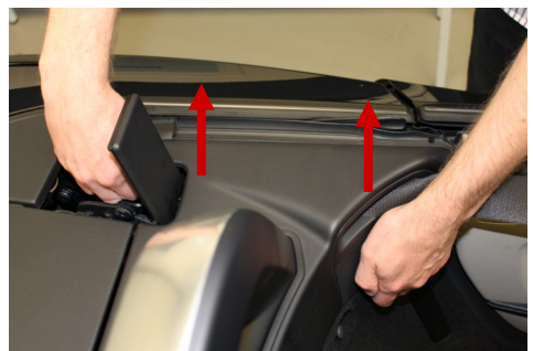
Unter die Verkleidung greifen und diese einige Zentimeter anheben und lösen
