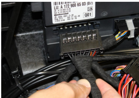
Einstecken des Modulkabelbaums in das Steuergerät
