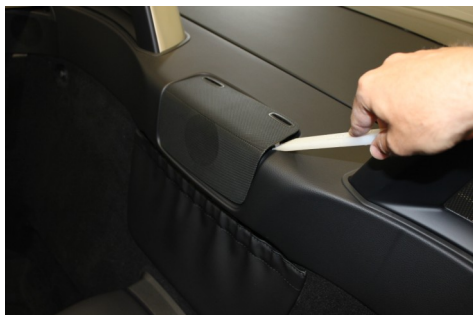
Mittlere Verkleidung entfernen und ggf. abstecken
