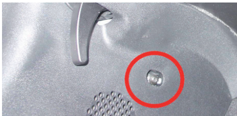
Schraube hinter Kappe lösen und Seitenverkleidung entfernen
