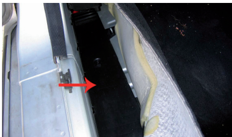
Teppich nach innen klappen und Kabelkanal öffnen
