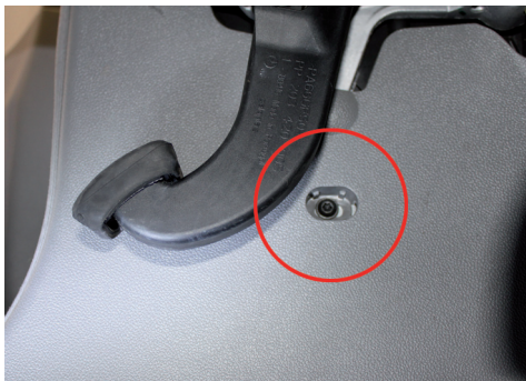
Torx 20 Schraube hinter Kappe lösen
