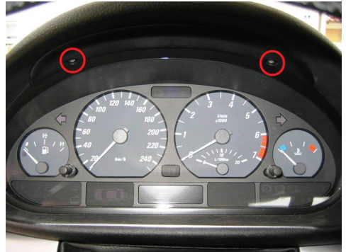
Torxschrauben am Kombiinstrument lösen und nach vorne herausziehen.
