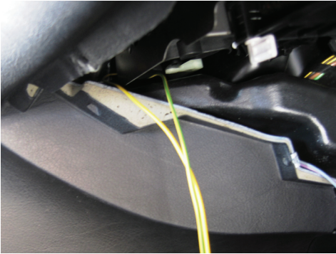
Das gelb und gelb/grüne Kabel mit Hilfe eines Zugdrahtes vom Fußraum hinter das Kombiinstrument ziehen.
