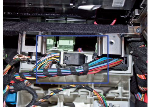
Durch Umlegen des weißen Einziehbügels nach rechts wird der Stecker vom Steuergerät gelöst.
