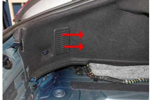
Entfernen des Lüftungsgitters
