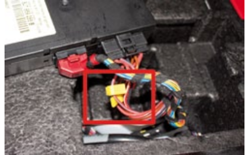
Anbringen der beiden Abgreifklammern für die Stromversorgung des Moduls.
