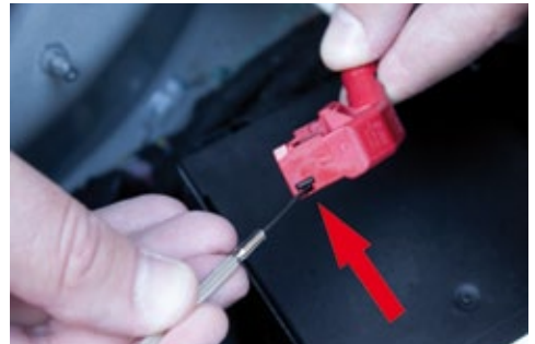
Kabelbinder entfernen. Rasthaken entriegeln, dann Buchsenleisten aus dem Steckergehäuse ziehen.
