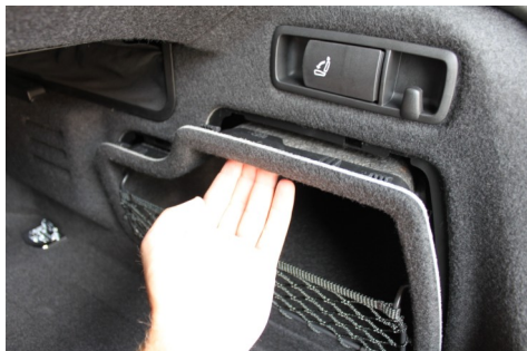
Öffnen der Serviceklappe im Kofferraum auf der Beifahrerseite
